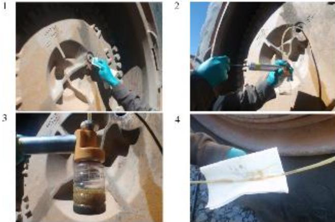
Figura 3: Proceso de extracción de muestra de aceite lubricante. El aceite es la "sangre" de la máquina, es el fluido vital que permite su funcionamiento
