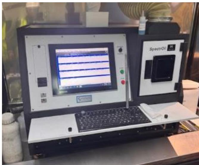
Figura 9: Equipo espectrofotómetro
