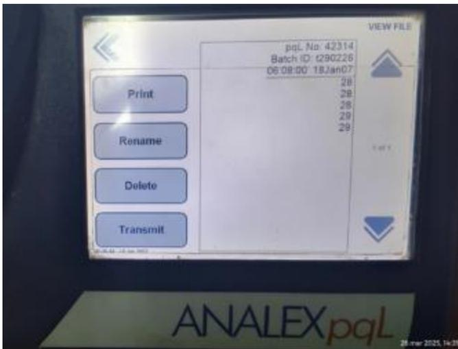
Figura 20: Pantalla equipo contador de partículas ferrosas PQ
